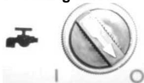
Чтобы включить подачу СОЖ, установите выключатель в положение "ON" – «ВКЛ».
