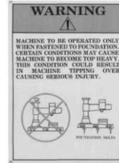
5. Для безопасности зафиксируйте станок с помощью анкерных болтов.
